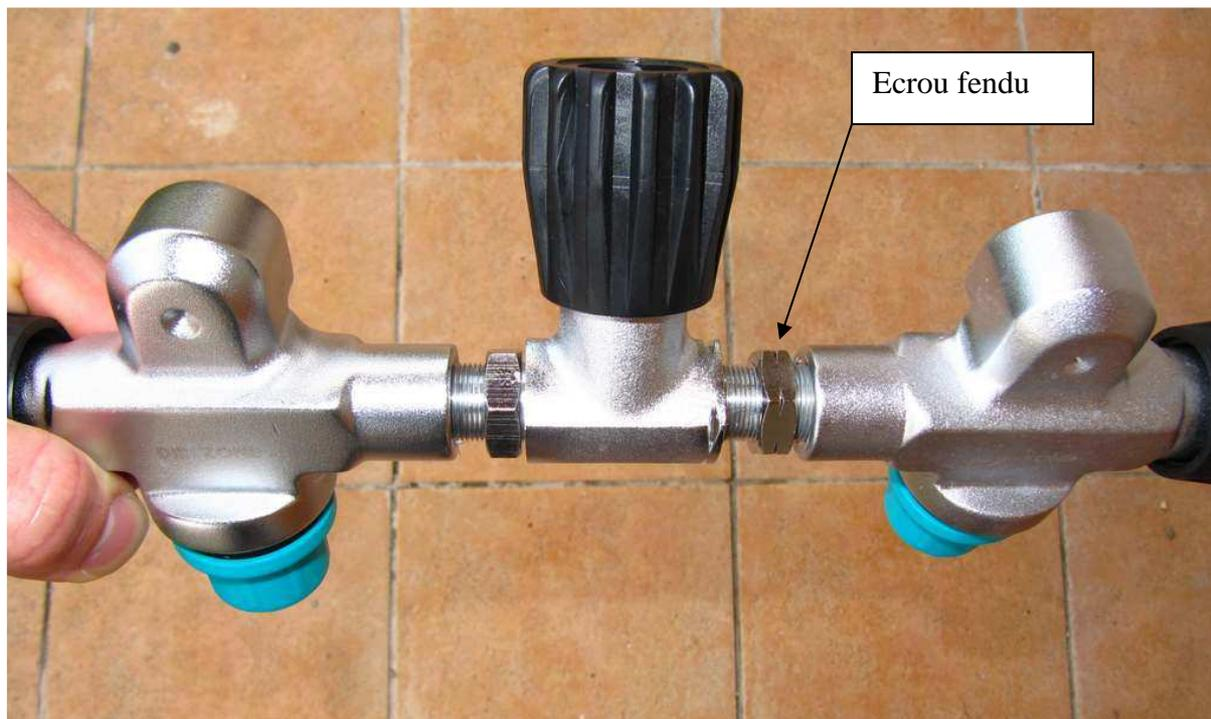
En approchant les fûts et en veillant que le pas de vis « accroche » en même temps sur les deux robinets, vissez l'isolateur en tournant vers l'avant. Vissez à fond, puis dévissez d'environ 3 tours.
